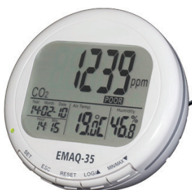
EMAQ-35 Luftqualitätsanzeiger und -Datenlogger als Tischaufsteller, inkl. Datenauswertesoftware
