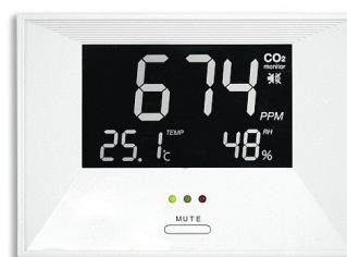
EMAQ-31 Luftqualitätsanzeiger als Tischaufsteller oder für Wandaufbau, mit Temp. und Feuchteanzeige und mit Ampelfunktion (Dual-Beam NDIR Sensor)
