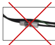
Ungeeignete Position des Kondensatbehälters
