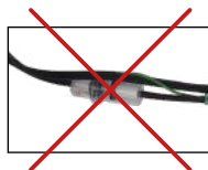
Mauvaise position du pot à condensat
