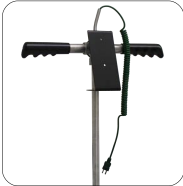
Kompostsonde mit KSP Halterung
