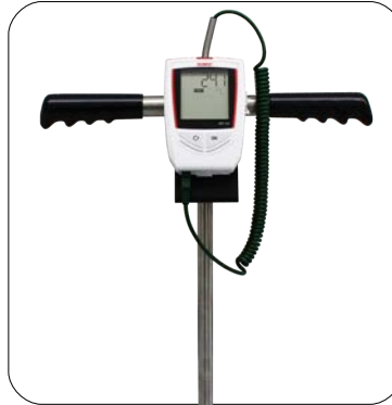
Montagebeispiel mit Temperatur-Datenlogger
