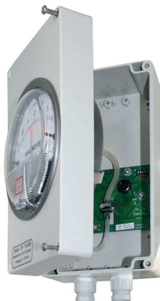
**Die Transmitterplatine ist im Inneren des Gehäuses verbaut.**
