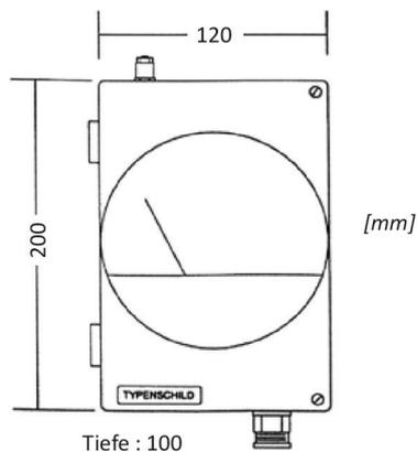
Die Manometer der Serie DELTA CP sind im Gehäuse verbaute Differenzdruckanzeiger mit einem analogen Strom- oder Spannungsausgang (4-20mA oder 0-10V). Die Kunststoffgehäuse sind besonders robust und optional auch mit der Schutzklasse IP65 erhältlich.
