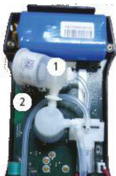
Abgezogener weißer Schutz mit Sensor
