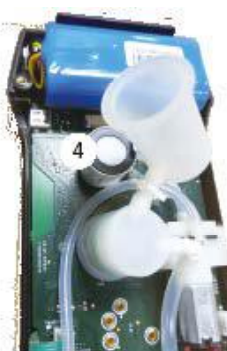
Neuer auf die Leiterkarte gesteckter Sensor
