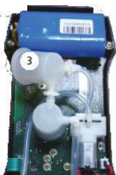
Aus dem weißen Schutz herausgezogener Sensor
